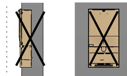
Afin que l'installation soit correcte, du jeu doit être présent entre la borne et les murs.
